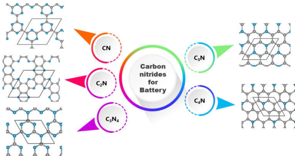
شکل ۲: ساختارهای هندسی نیتريدهای کربن مبتنی بر N پیریدینیک و گرافیتی کره‌های خاکستری نشان‌دهنده اتم‌های کربن و رنگ آبی نشان‌دهنده اتم‌های نیتروژن در ساختارهای نیتريد کربن دوبعدی است.
