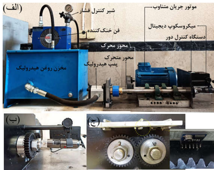
شکل ۱- (الف) دستگاه آزمون چرخنده، (ب) استفاده از میکروسکوپ دیجیتال برای تصاویر دیجیتال و (ج) درگیری جفت دنده و بزرگنمایی تصویر سنسور دمای مادون قرمز
